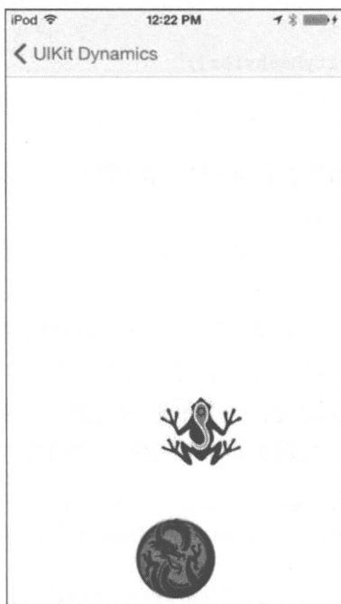
图 1-3 将弹跳效果应用在龙图片和青蛙图片上，展示了重力效果和设置 UIAttachmentBehavior 阻尼、频率的效果
